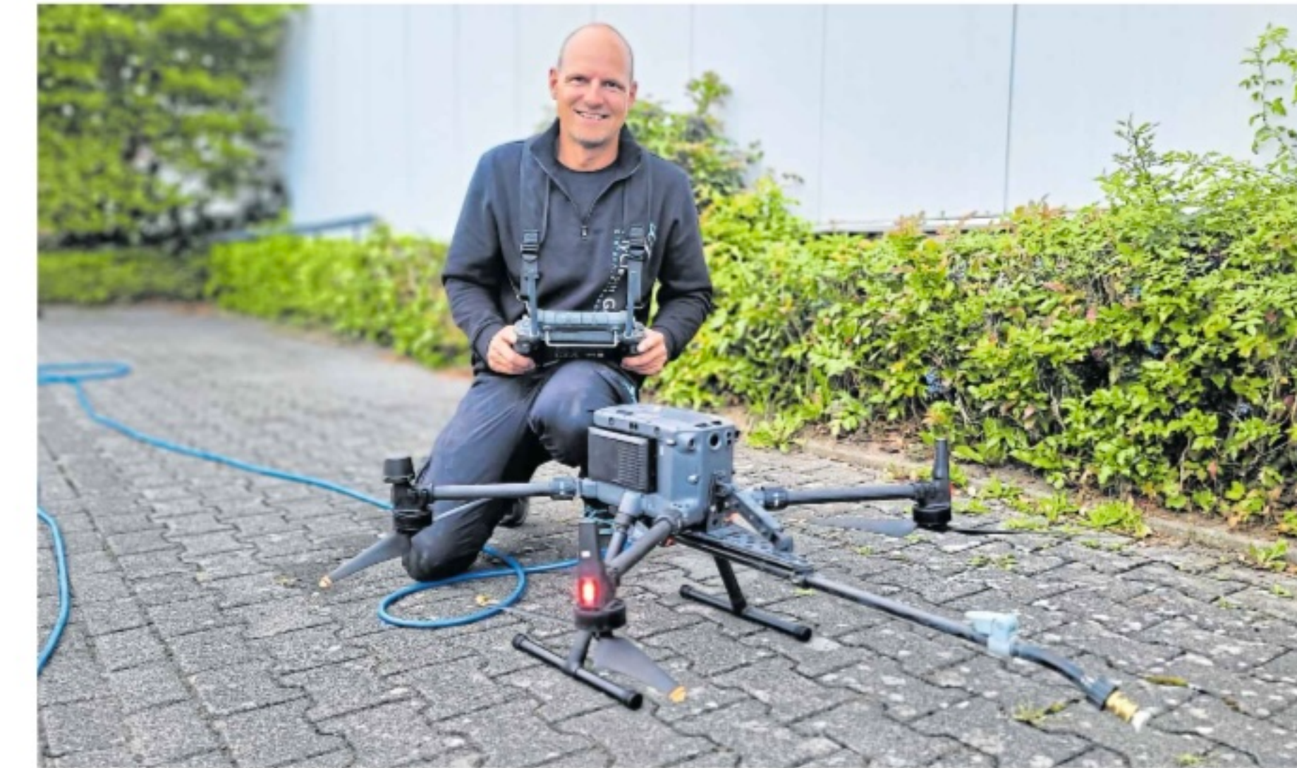
Oliver Dreweskracht und seine Drohne: Mit vier Rotoren und einer Düse kann sie bis zu 1000 Quadratmeter Fläche pro Tag putzen.
